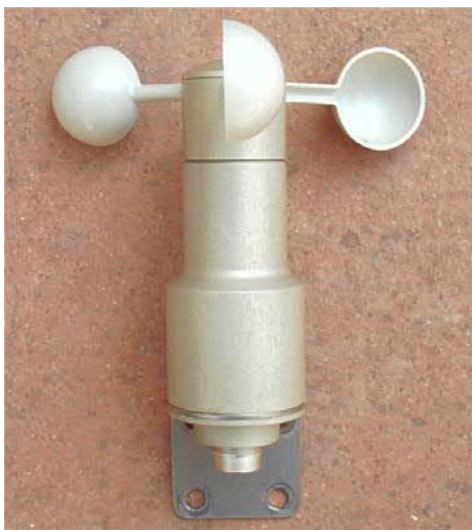
Fig. 4 – Il sensore anemometrico
