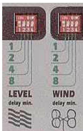
Fig. 5 – I dip switch per la programmazione dei tempi
